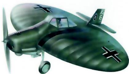
своего рода «летающие тарелки», которые по своей конструкции были ближе к вертолетам, нежели к самолетам. Например, экспериментальный аппарат «Фокке-Вульф-500» «Шаровая молния» Курта Танка представлял собой дискообразный корпус типа «летающее крыло», над бронированной кабиной которого размещались лопасти большого диаметра, вращаемые турбореактивным двигателем.
